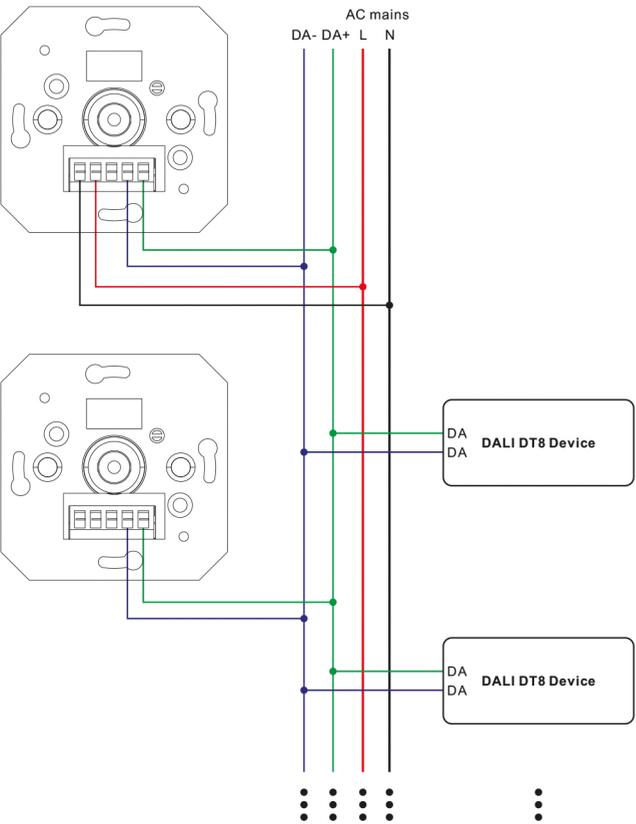
Verdrahtungsschema mit 2 MCUs, die über das Wechselstromnetz mit Strom versorgt werden, um bis zu 100 DALI-Aktoren zu steuern
