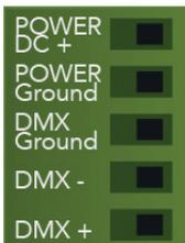
2b) Anschluss Power/DMX mittels RJ 45 Kabel:
